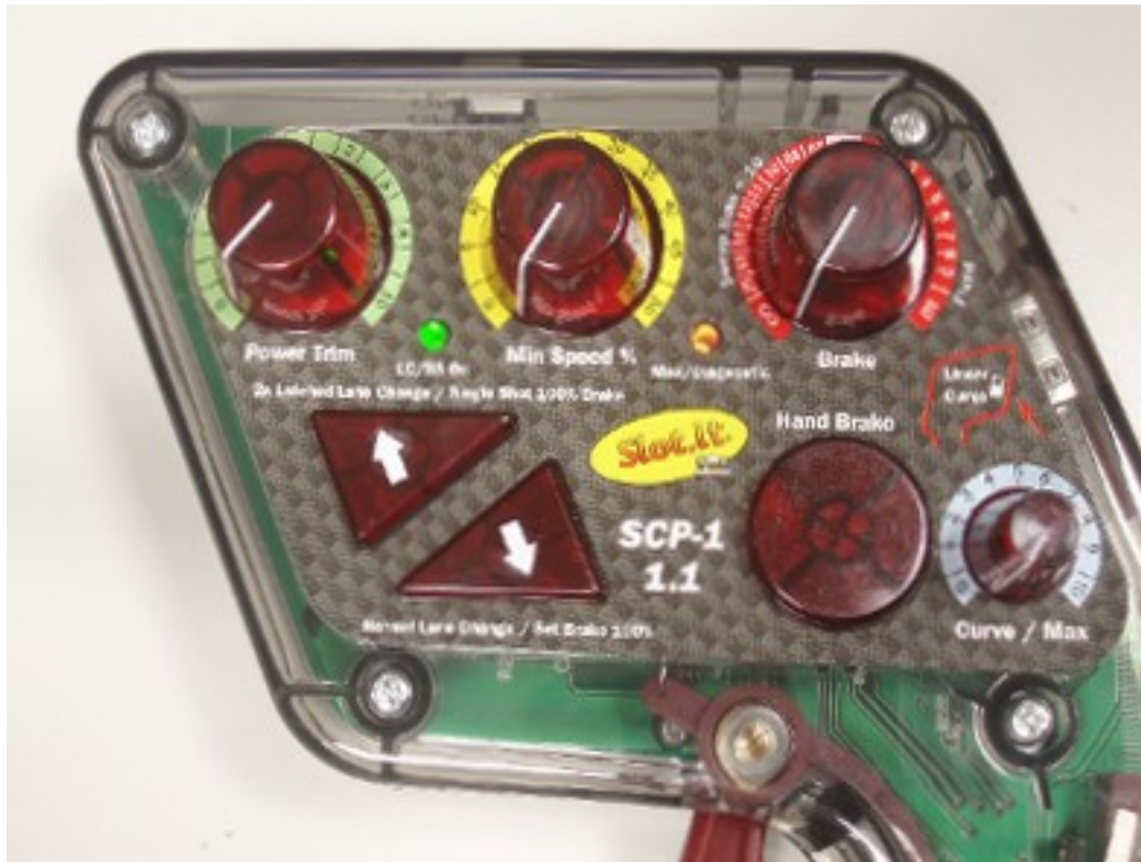
3- LED gauche verte, LED droite rouge + verte (semble orange)
